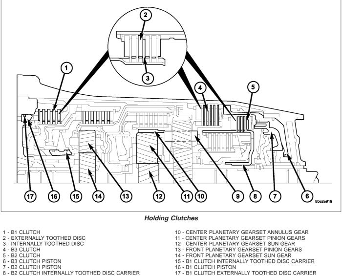
9 - REAR PLANETARY GEARSET PLANETARY CARRIER
